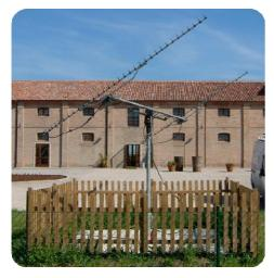
L'osservazione è effettuata prima con una sola delle antenne e poi con entrambe, in modo da osservare e riconoscere il fenomeno dell'interferenza tra onde elettromagnetiche, per poi poterlo analizzare e ricavarne (quantitativamente) le caratteristiche delle onde incidenti sulle due fenditure.
